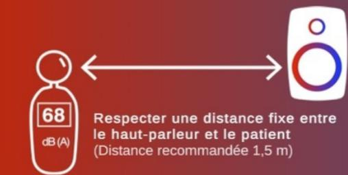
Positionner un sonomètre au point d'écoute puis ajustez le volume du haut-parleur ou le réglage ci-contre afin d'obtenir 68 dB(A).
